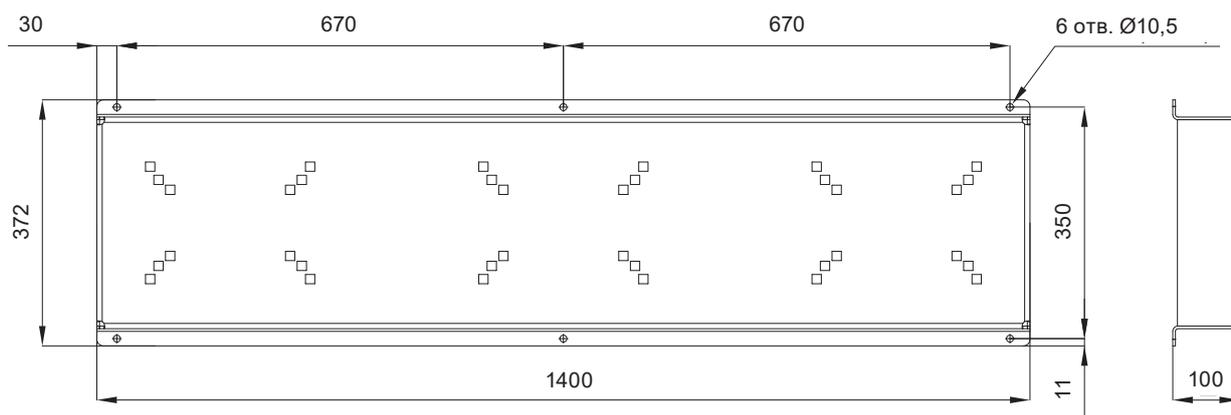
Габаритные размеры рамы-основания указаны в мм.
