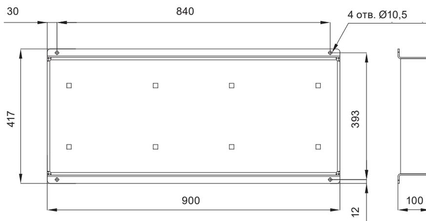
Габаритные размеры рамы-основания указаны в мм.
