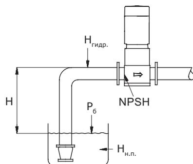
**Рис. 2** Параметры для расчета минимального давления на входе
