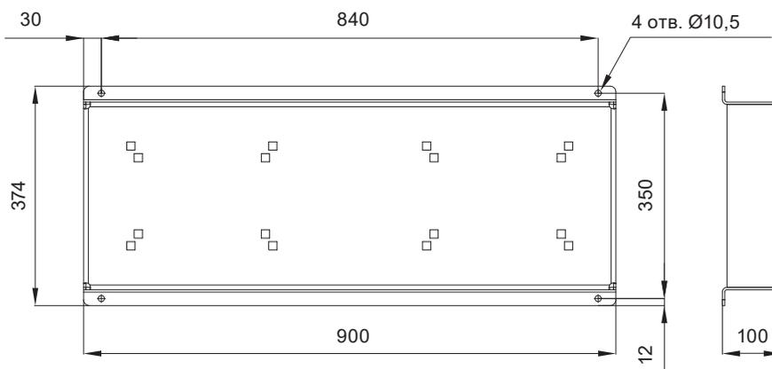
Габаритные размеры рамы-основания указаны в мм.
