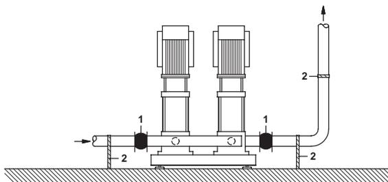
Рис. 3 Крепление трубопровода
