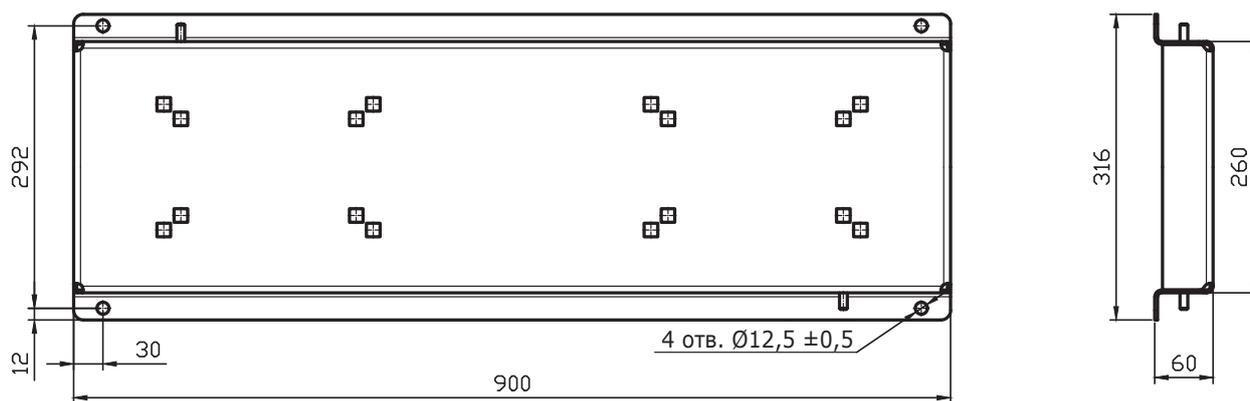
Габаритные размеры рамы-основания указаны в мм.
