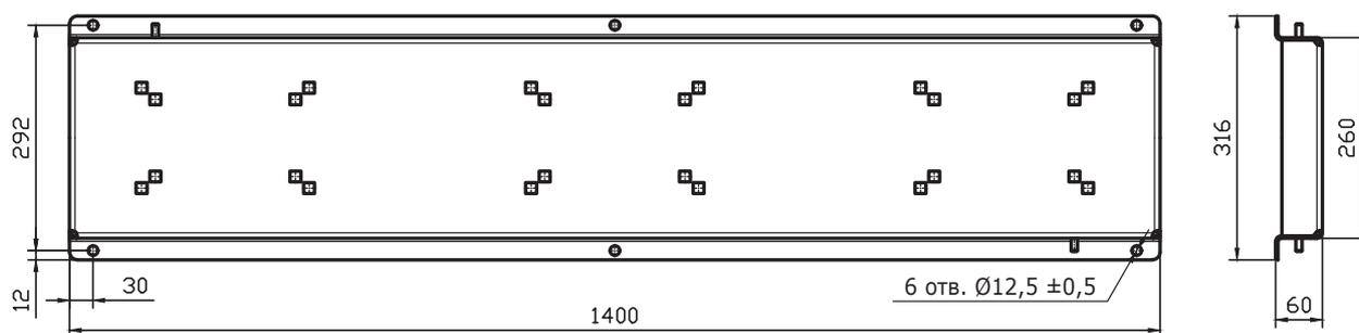
Габаритные размеры рамы-основания указаны в мм.
