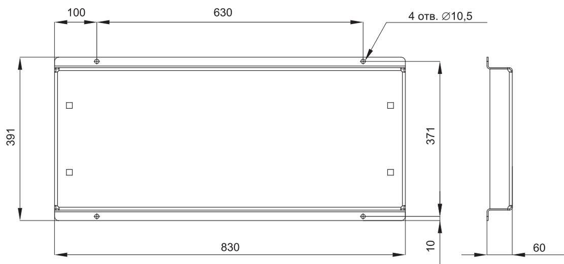
Габаритные размеры рамы-основания указаны в мм.
