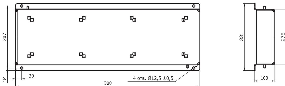
Габаритные размеры рамы-основания указаны в мм.
