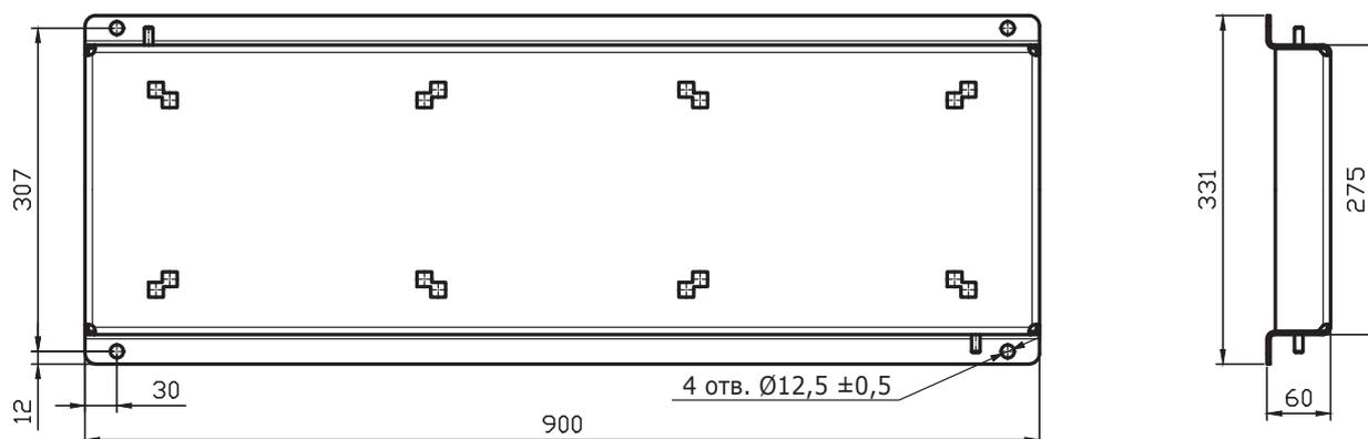
Габаритные размеры рамы-основания указаны в мм.
