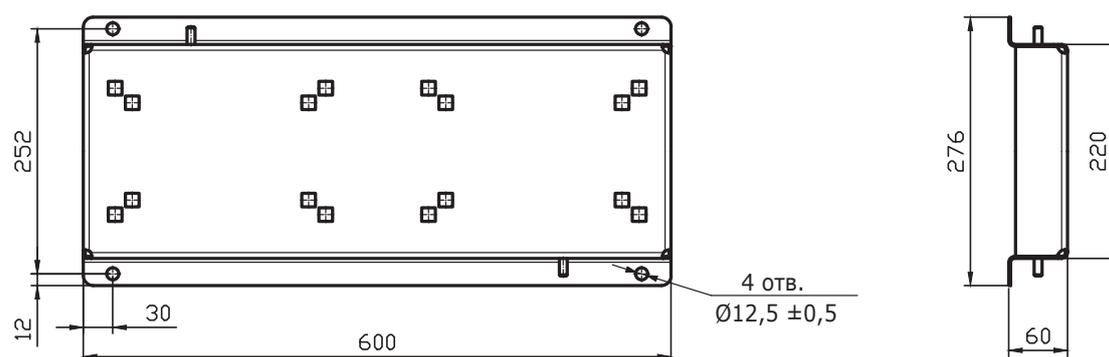
Габаритные размеры рамы-основания указаны в мм.
