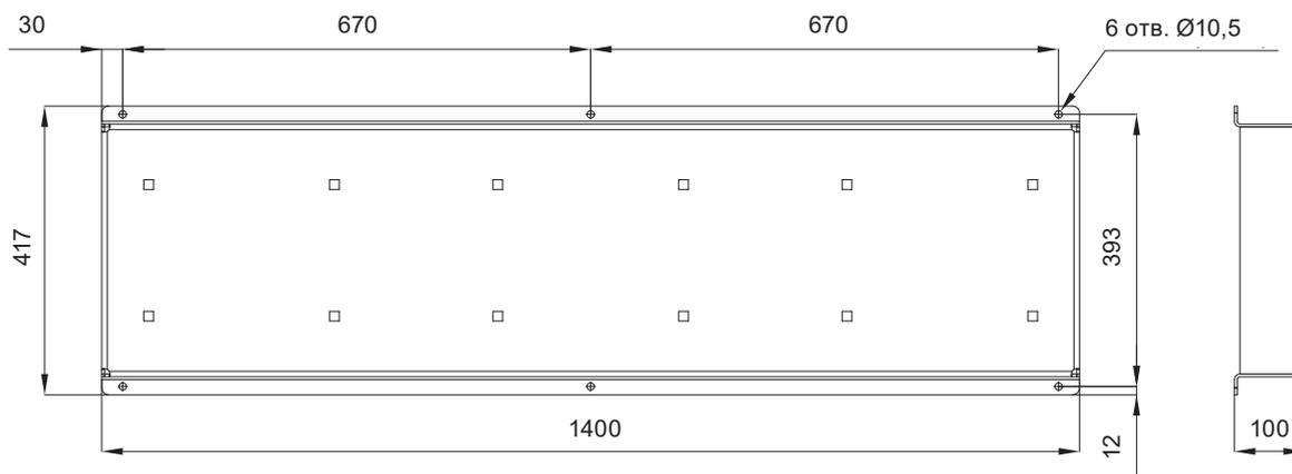
Габаритные размеры рамы-основания указаны в мм.
