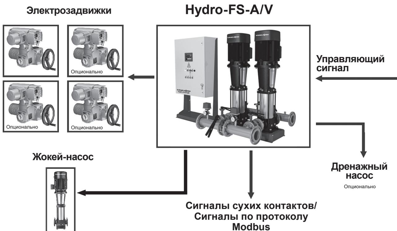
Рис. 11 Общая схема входящих и исходящих подключений
