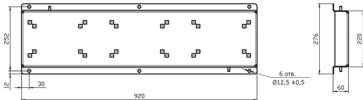
Габаритные размеры рамы-основания указаны в мм.
