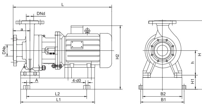
**Габаритный чертеж насоса VNK**
