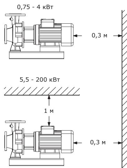
**Рис. 16** Расстояния до стен/потолка для насосов NBV, VNK\*
