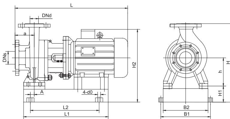
**Габаритный чертеж насоса VNK**
