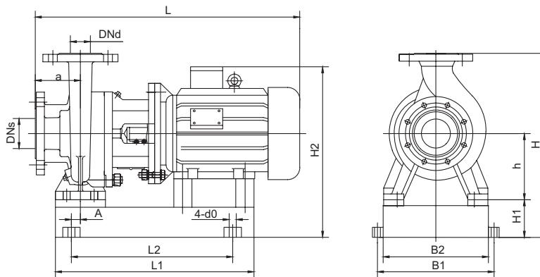
**Габаритный чертеж насоса VNK**
