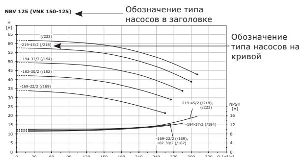
**Рис. 21** Чтение кривых QH насосов NBV и VNK
