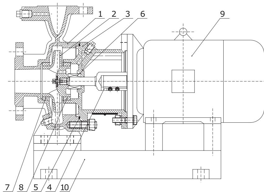
**Рис. 11** Насос NBV в разрезе
