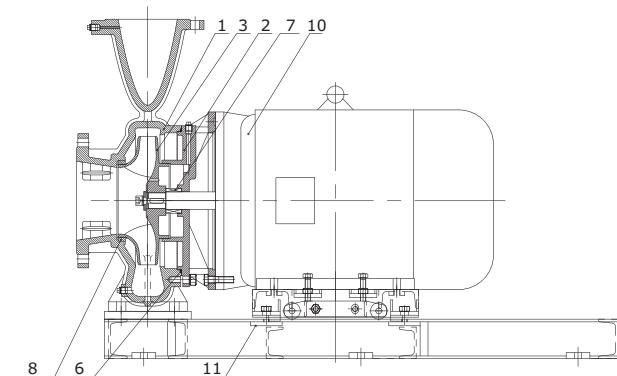
**Рис. 18** Насос NBV в исполнении с раздвижной рамой
