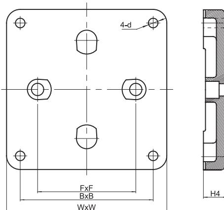
**Рис. 20** Примеры и размеры плит-оснований для насосов ТРВ
