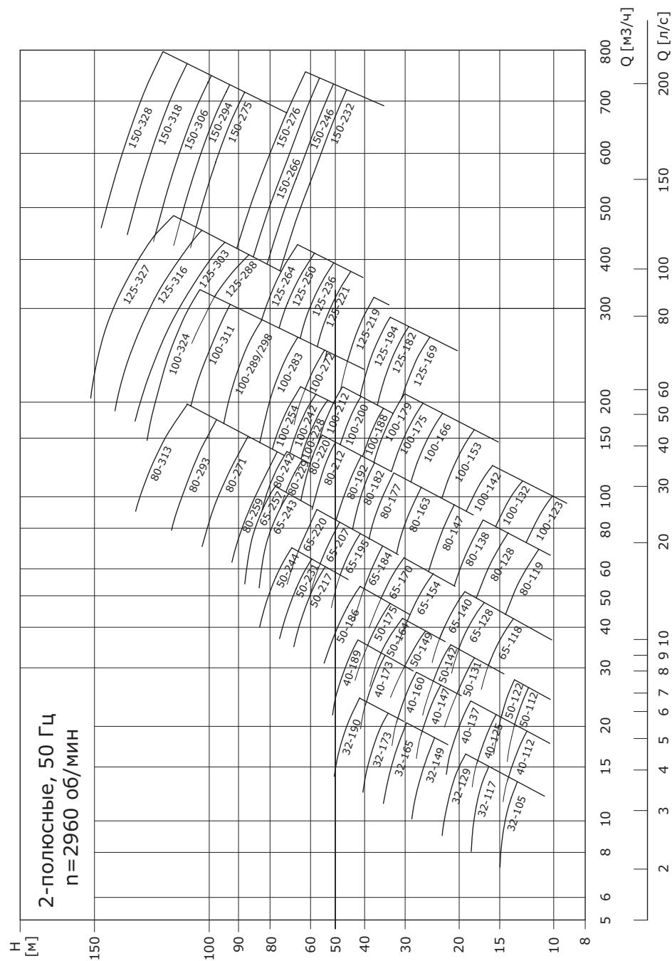
**Рис. 7** Диапазон характеристик 2-полюсных насосов NBV, VNK
