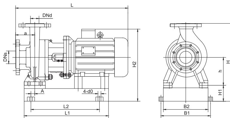
**Габаритный чертеж насоса VNK**
