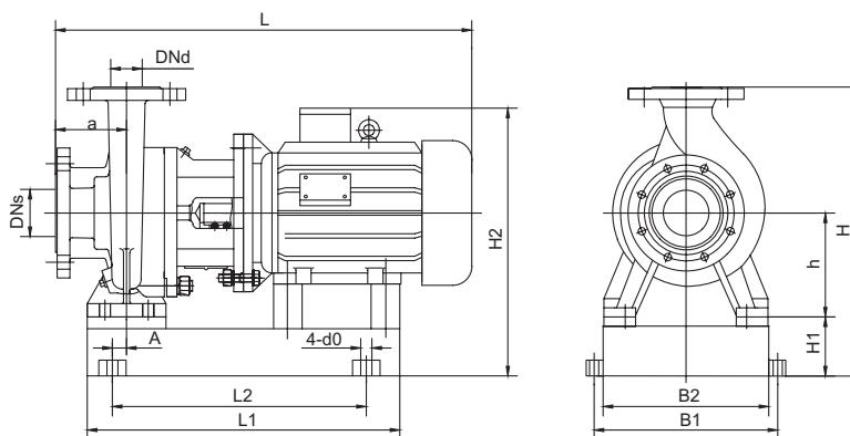
**Габаритный чертеж насоса VNK**
