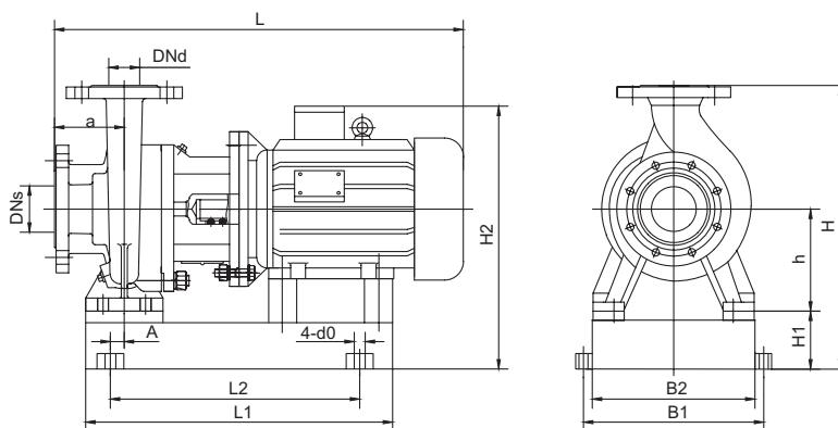
**Габаритный чертеж насоса VNK**
