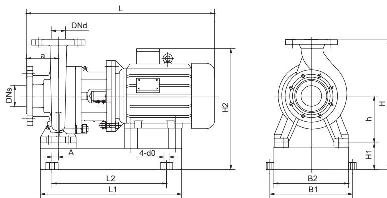
**Габаритный чертеж насоса VNK**
