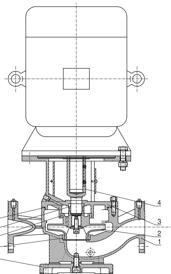
**Рис. 10** Насос ТРВ в разрезе
