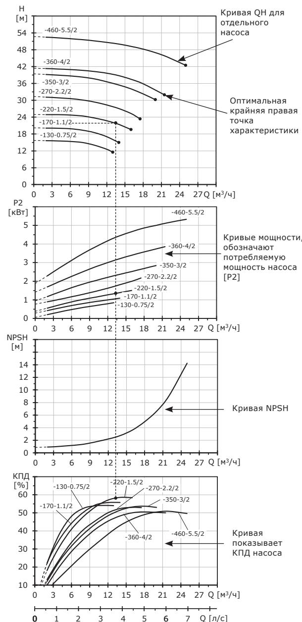
**Рис. 22** Пример диаграммы рабочих характеристик насоса TPV
