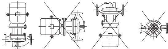
**Рис. 14** Примеры допустимого монтажа насосов TPV
