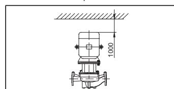
**Рис. 15** Расстояния до стен/потолка для насосов TPV
