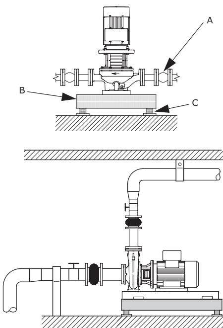
**Рис. 17** Фундамент для насоса TPV, NBV, VNK\*
