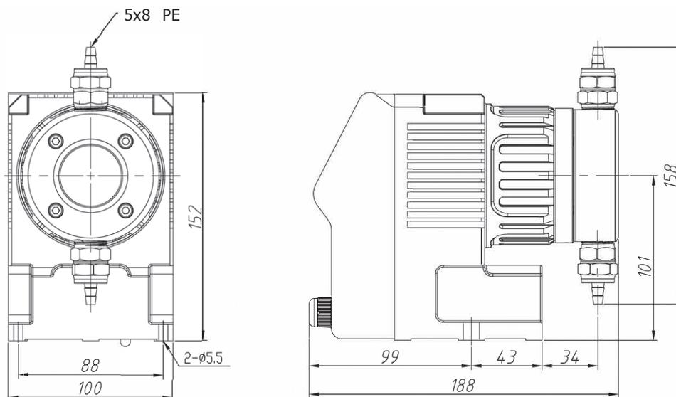
Рис. 6 Габаритный чертёж JLM-S с дозировочной головкой SS
