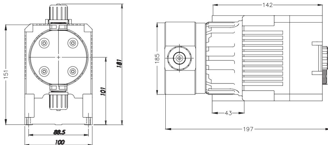
Рис. 4 Габаритный чертёж JLM(-P) с дозировочной головкой PVC
