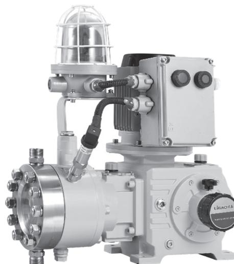
Двойная мембрана с контролем утечек защищает насос и персонал предприятия при разрыве первого слоя мембраны. Насос останавливается в течение 0,2–6 секунд после разрыва первого слоя мембраны и этим автоматически включает звуковую и световую тревогу.
