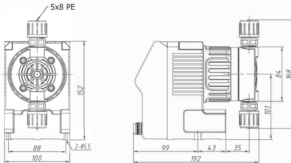
Рис. 5 Габаритный чертёж JLM-S с дозировочной головкой PVC и PVDF
