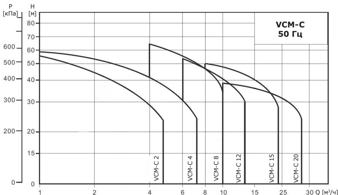
Рис. 14 Диапазон характеристик насосов VCM-C 50 Гц
