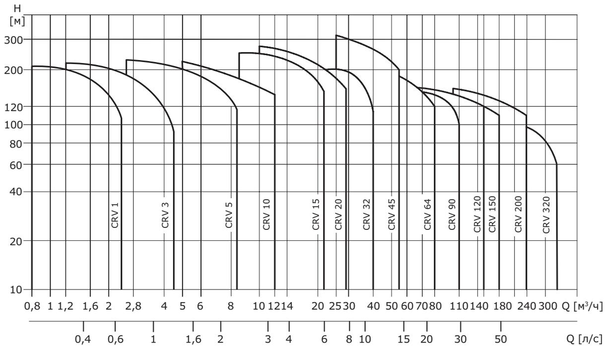
Рис. 2 Диапазон характеристик насосов CRV 50 Гц
