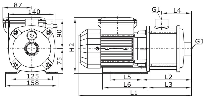
Рис. 19 Габаритный чертеж VCM-C 2
