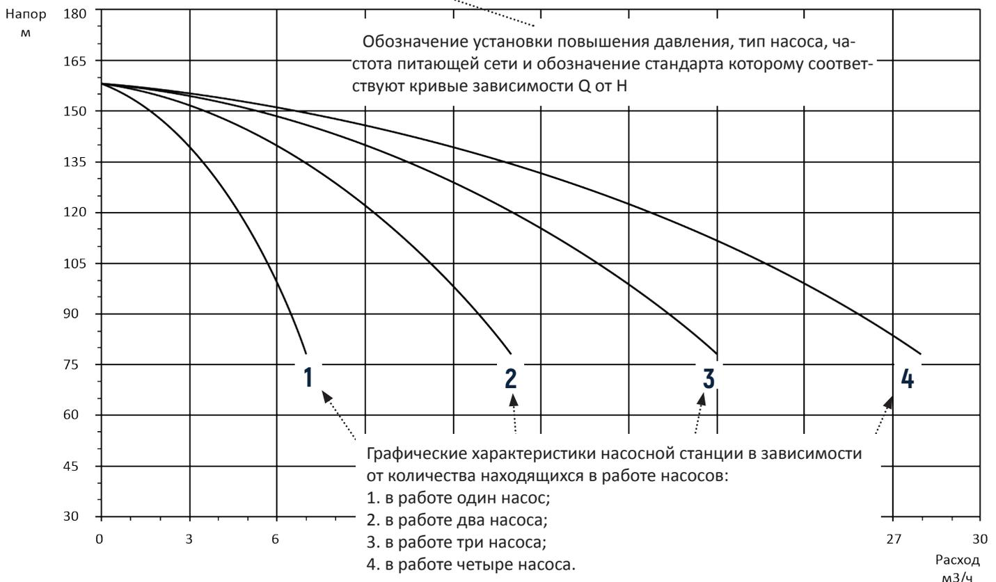
Рис. 12 Описание графических характеристик установок повышения давления
