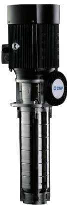
Погружные несамовсасывающие многоступенчатые центробежные электронасосы серии CDLK/CDLKF, оснащены стандартными электродвигателями, вал двигателя соединен непосредственно с валом электронасоса через муфту, при необходимости электронасос может быть оснащен защитой от перегрузки, которая защищает электронасос от «сухого хода», отсутствия фазы и т.д. Чтобы выполнить требование по глубине установки в емкости с водой, можно установить полевой корпус для изменения длины электронасоса.
