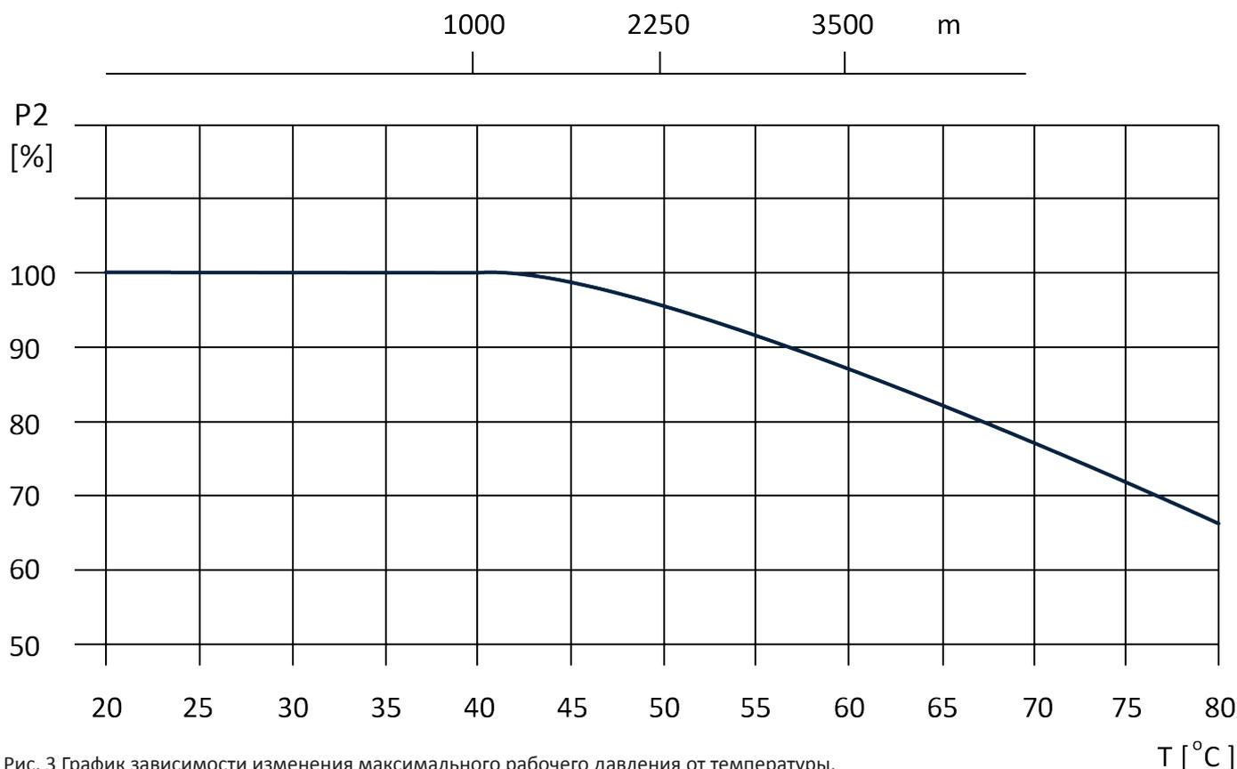
Рис. 3 График зависимости изменения максимального рабочего давления от температуры.
