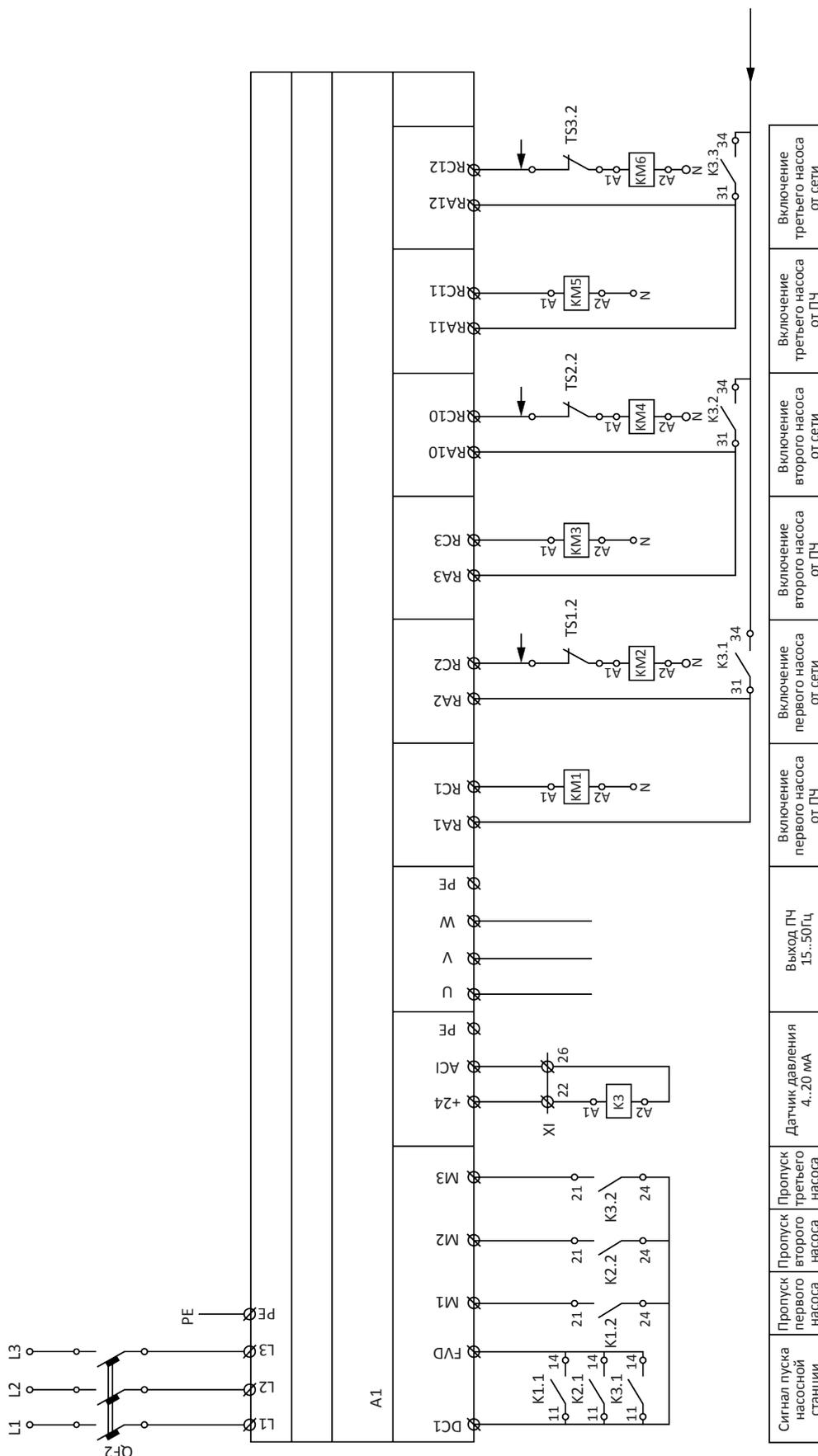
Схема FCC – частотно-каскадное регулирование (3 насоса) (Продолжение)
