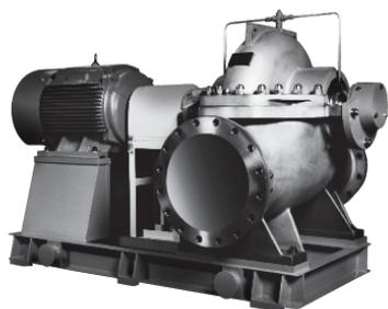
Одноступенчатые центробежные электронасосы с рабочим колесом двухстороннего входа и разъемным корпусом, горизонтально или вертикально устанавливаемые одноступенчатые электронасосы с корпусом, имеющим продольный разъем, с радиальным рабочим колесом двойного всасывания, присоединительными фланцами на корпусе.
