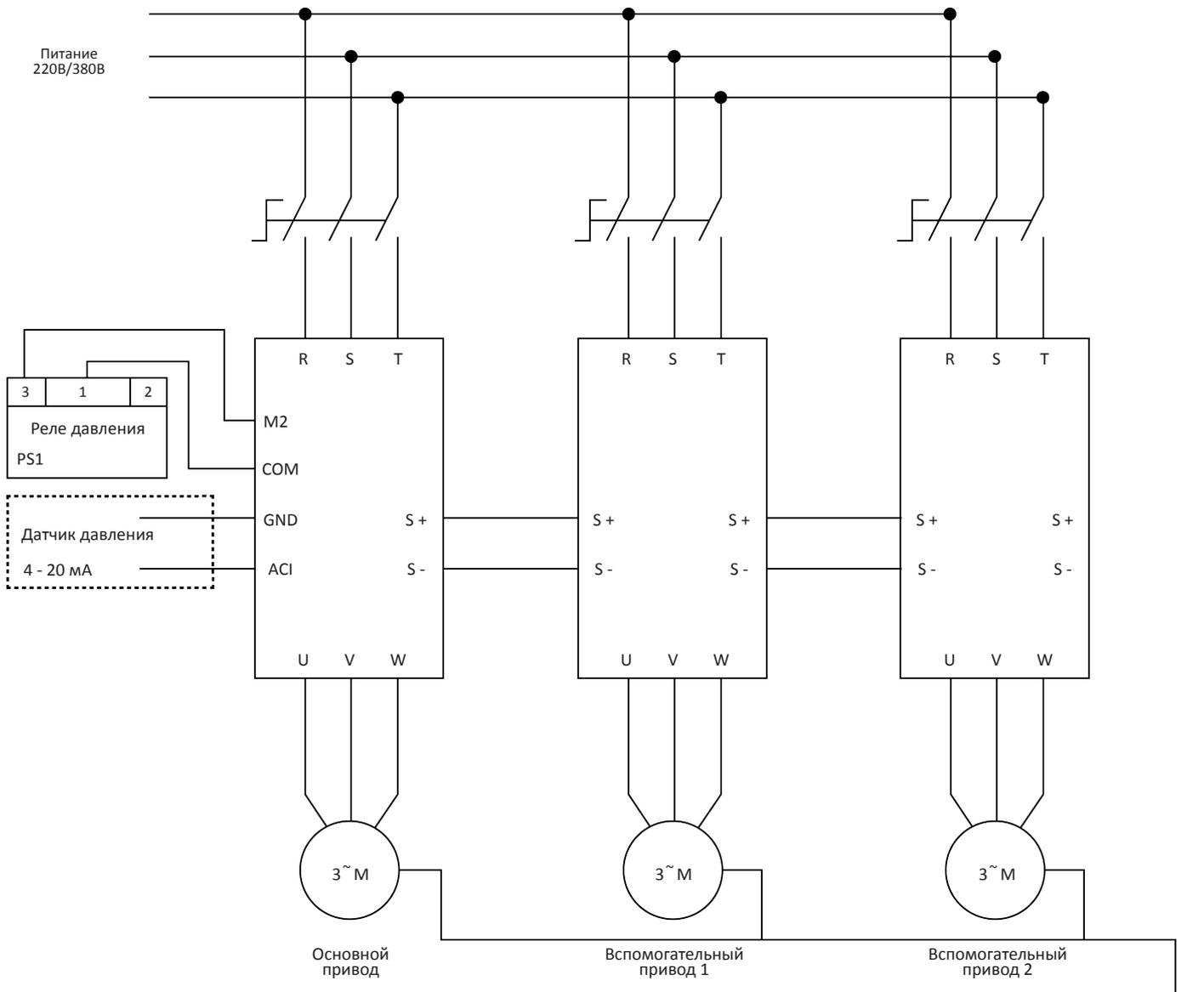
Для повышения надежности и обеспечения работы насосной станции при выходе из строя датчика давления или основного преобразователя частоты возможно из одного вспомогательного привода сделать дополнительный основной привод. Для этого к дополнительному основному приводу необходимо подключить датчик давления и датчик «сухого хода» (также как к основному приводу) и на дополнительном основном приводе необходимо замкнуть вход M1-COM (параметр F7.00=1 - по умолчанию)
