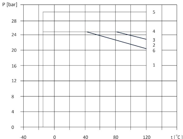
Рис. 2 График зависимости изменения максимального рабочего давления от температуры.
