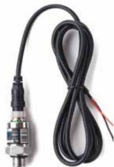
Датчик давления SP100, двухпроводной, 4...20 мА, +24 В, 0...15 атм, G1/4", длина кабеля 1,5 м, погрешность 0,5%
