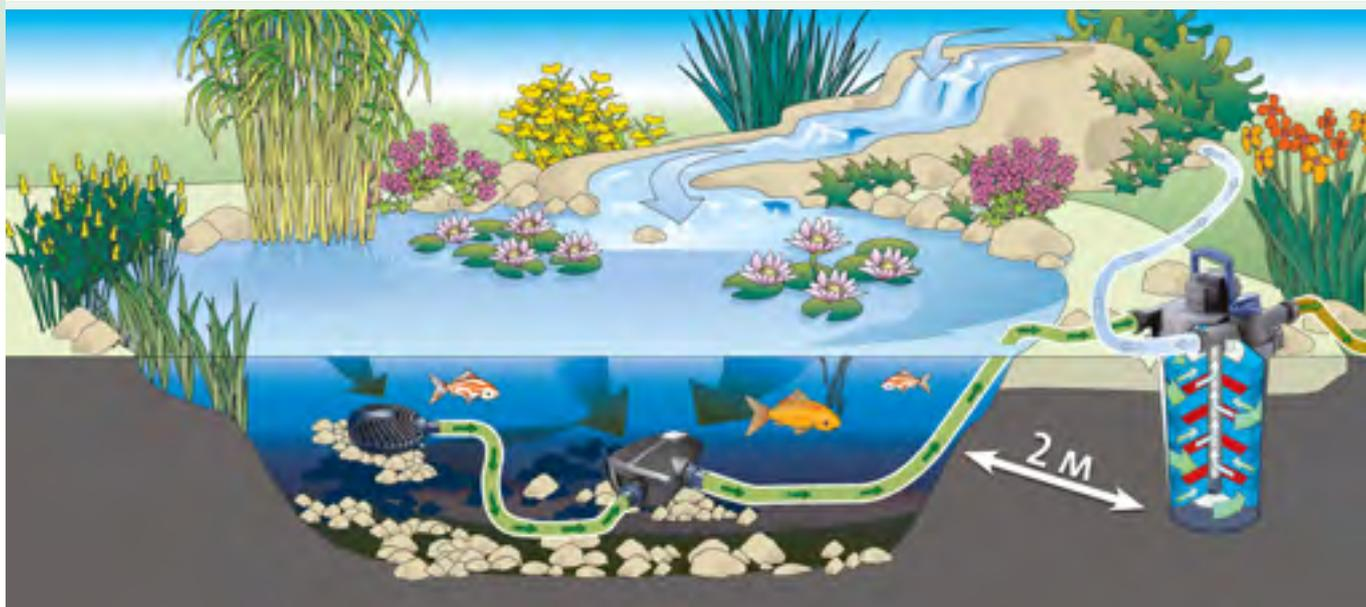
При помощи насоса вода подается в фильтр, который устанавливается в землю. При необходимости вода может направляться в ручей, расположенный выше.
