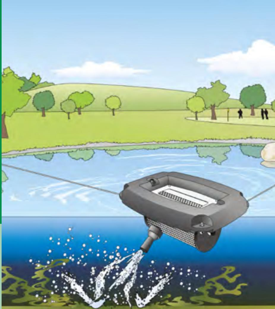
Схематическая диаграмма: Использование аэрата для пруда AquaAir 250 – оптимальное распределение кислорода в пруду
