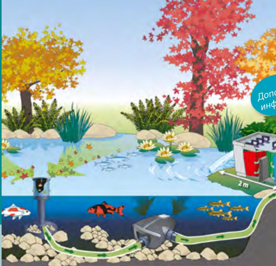
Схематическая диаграмма: использование AquaSkim вместе с насосом для фильтров и ручьев AquaMax Eco Premium
