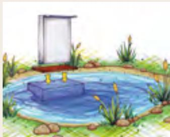
Затем Waterfall 30 помещается на эту ровную плиту: для этого просто привинтите два боковых крепления из нержавеющей стали.
