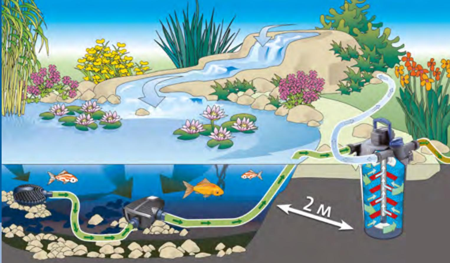
Схематическая диаграмма: Насос для фильтров и ручьев AquaMax Eco Premium (Про) в сочетании с напорным фильтром OASE FiltoClear (Про)
