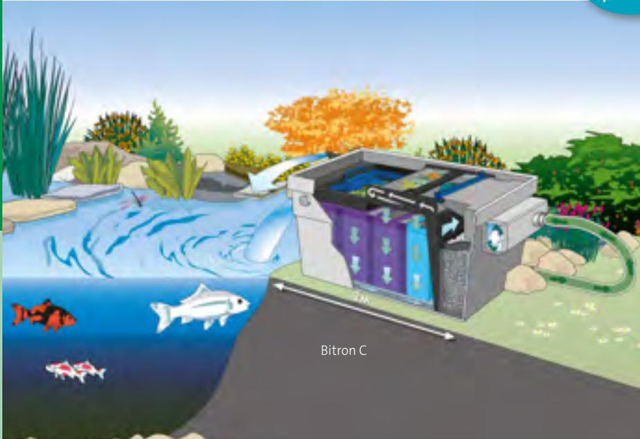
Схематическая диаграмма: УФ очиститель в сочетании с проточным фильтром OASE BioTec ScreenMatic<sup>2</sup>
