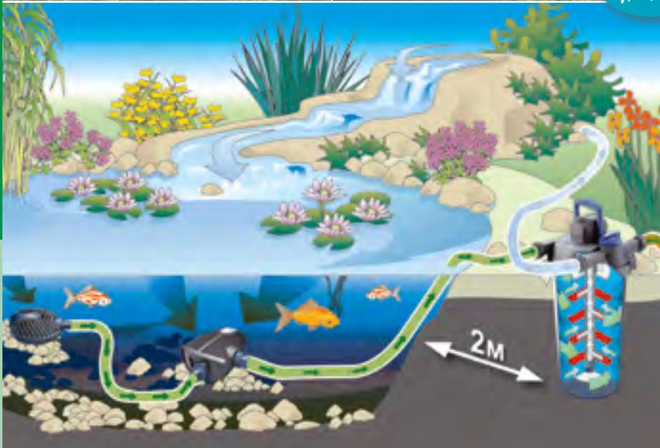
Схематическая диаграмма: Напорный фильтр FiltoClear в сочетании с насосом для фильтров и ручьев
