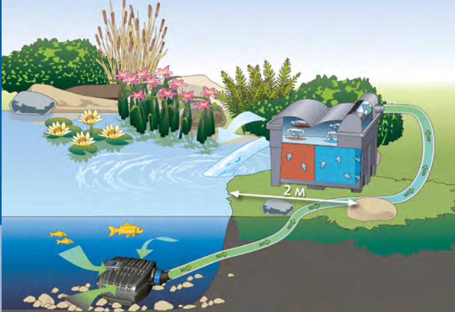
Схематическая диаграмма: Насос для фильтров и ручьев AquaMax Eco Classic (Старт) в сочетании с проточным фильтром OASE BioSmart (Старт)
