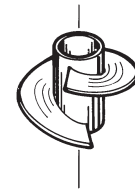
Рис. 6 Шнек на входе
